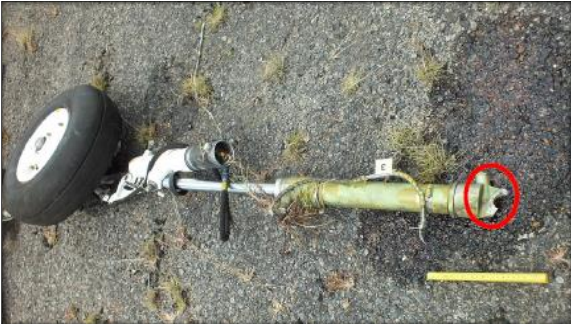
Fotografía No. 5: Condición Final Tren Principal Derecho (R)
