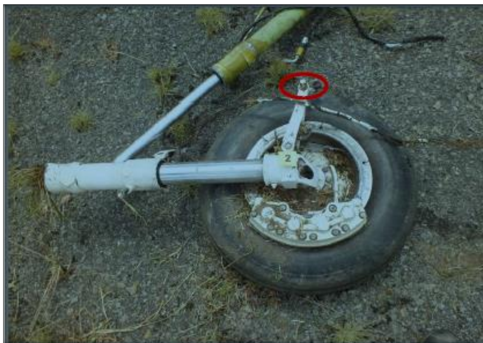
Fotografía No. 2: Condición Final Tren Principal Izquierdo (L). Se demarca el Perno que sujeta la Tijera de Alineación (Link Assy main Gear Strut)
