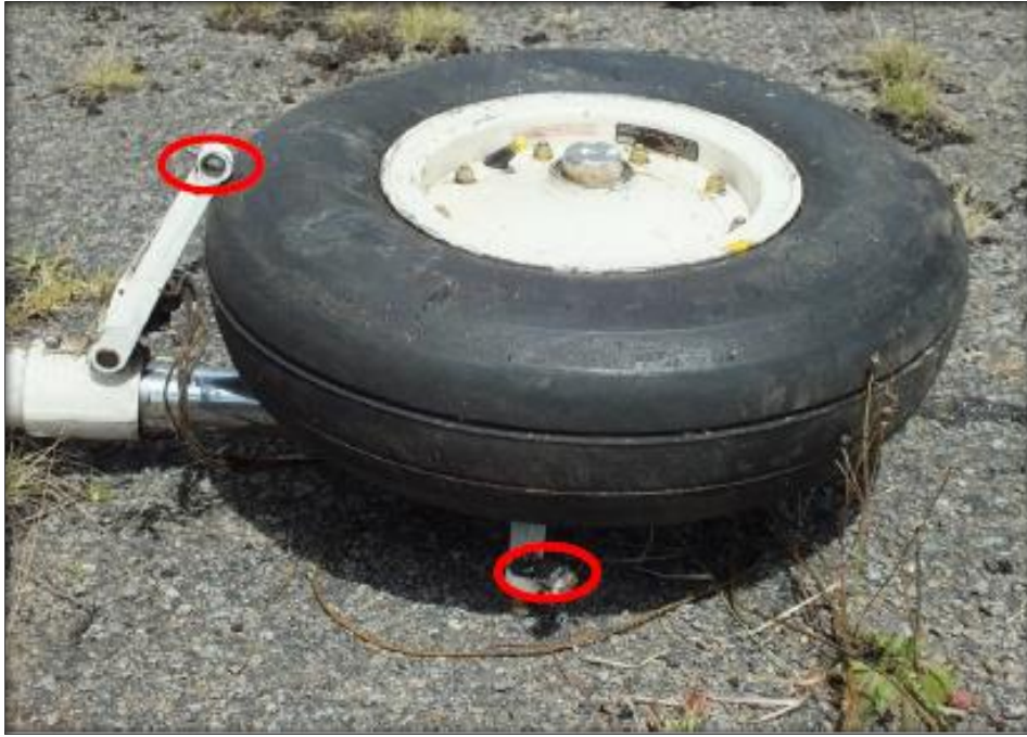
Fotografía No. 3: Condición Final Tren Principal Izquierdo (L)
