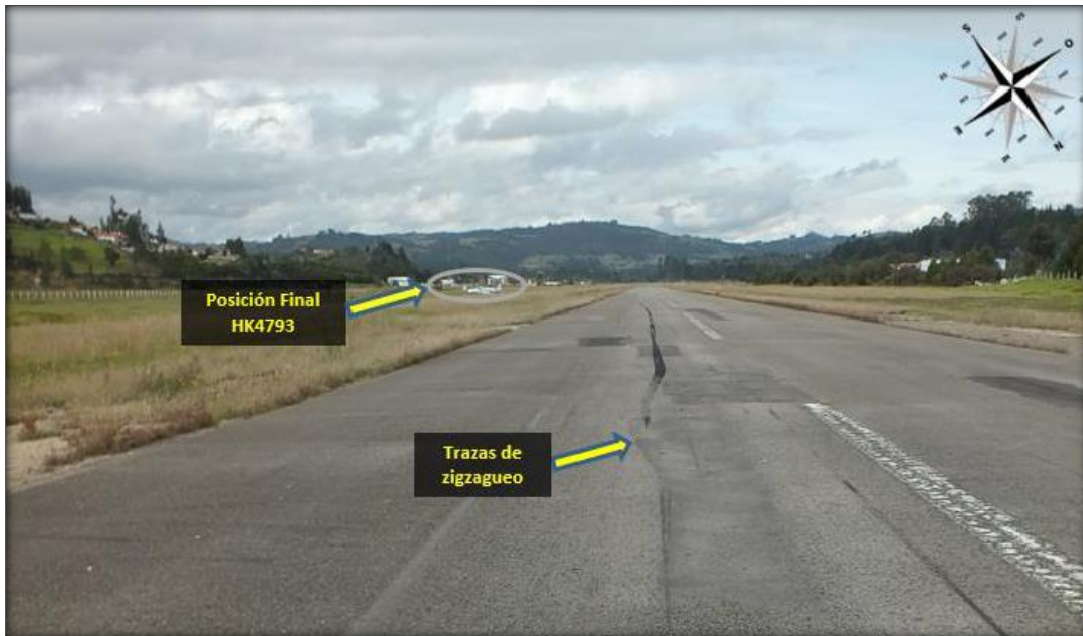
Fotografía No. 9: Marcas de Zigzagado sobre pista SKPA – 22/04
